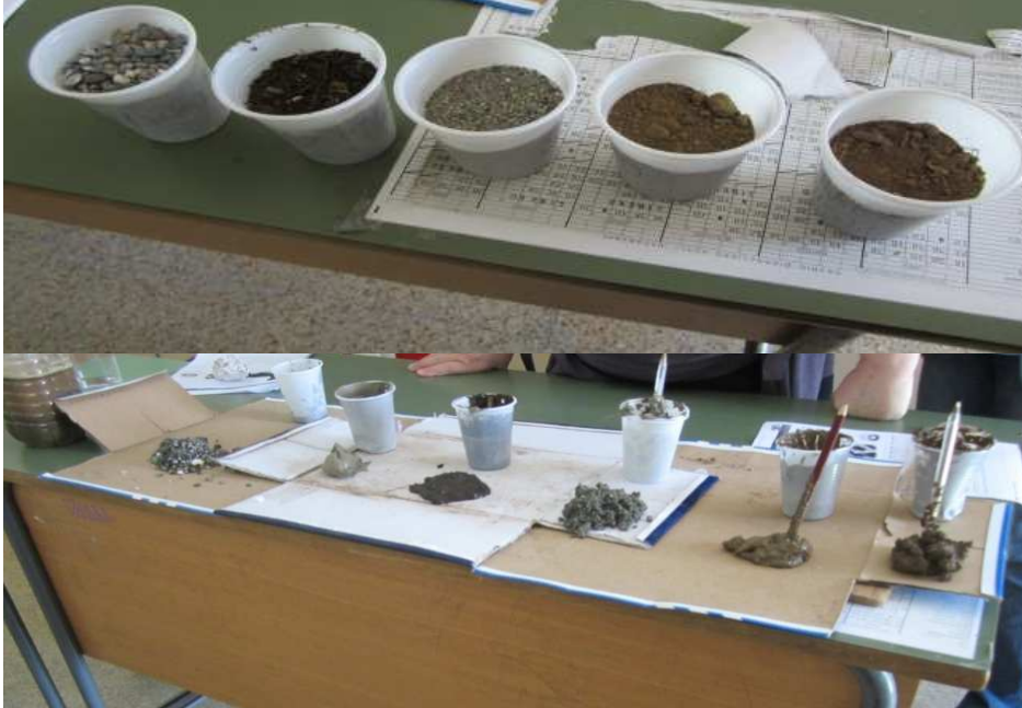
Fig. 3 Analisi e impasto dei diversi campioni: sabbia, ghiaia, argilla, humus, limo
